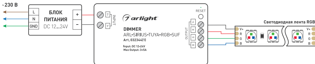
Рисунок 1. Пример схемы подключения диммера ARL-SIRIUS-TUYA-RGB-SUF
